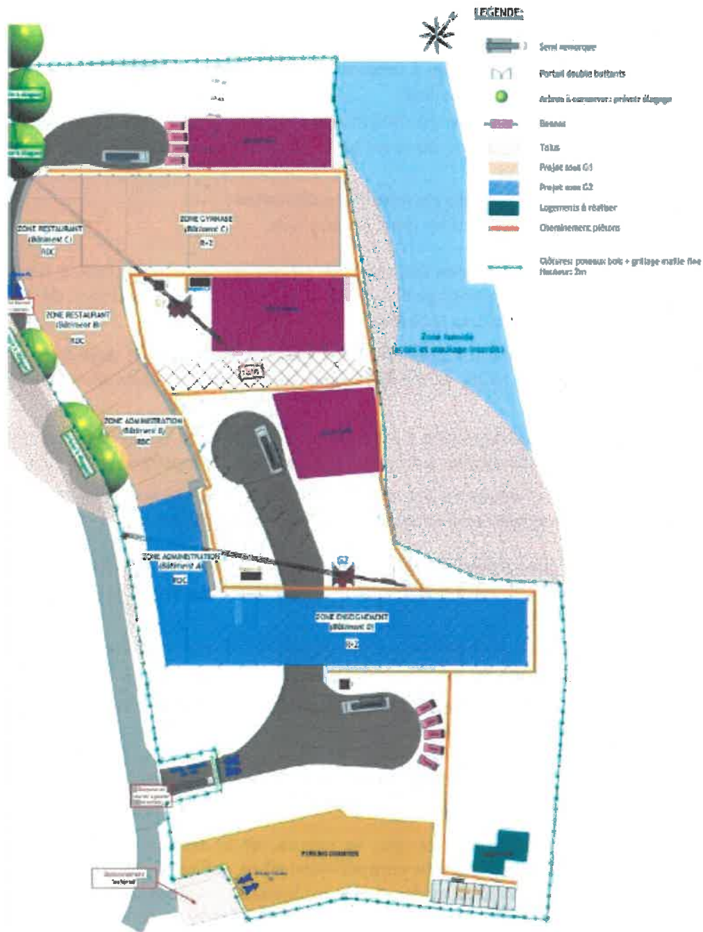
Figure 3 : Mise en défens des zones humides en phase chantier
